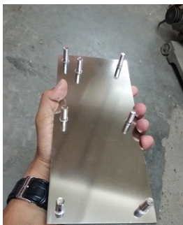
Gland Plate Stud Weld
